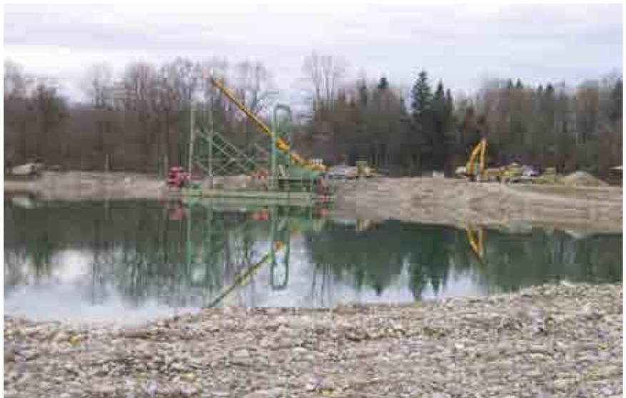
Kiesabbau mit Hilfe eines Schwimmbaggers
